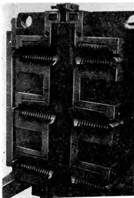
34-4. ábra. 24 kV 2500 A forgóátvezetős szakaszoló öntőszerszámának fele
